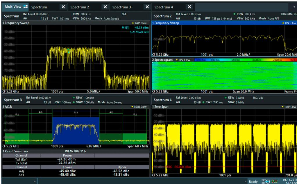
MultiView가 적용된 R&S®FPL1000 스크린샷. 시퀀서가 스펙트럼 측정, 인접 채널 파워 측정, 시간 도메인 측정(제로 스패ن), 스펙트럼 측정을 연속적으로 수행합니다. 결과가 선명하게 동시에 표시됩니다. 왼쪽 툴바에서 가장 자주 사용하는 메뉴 기능에 빠르게 접근할 수 있습니다. 다른 측정은 상단 탭을 사용하여 활성화할 수 있습니다.
