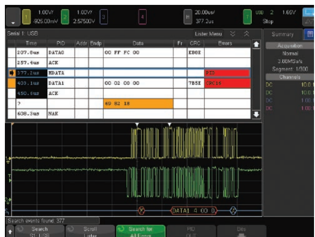
그림 20. USB 2.0 트리거, 디코딩 및 “리스트” 표시
