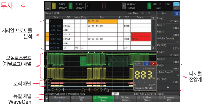
그림 17. 4000 X-시리즈는 5가지 계측기 기능이 매끄럽게 하나로 통합되어 있습니다.
