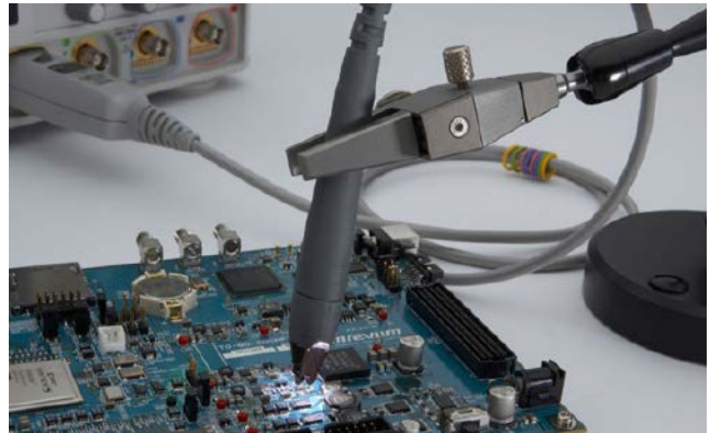
그림 34. N2750A InfiniiMode 프로브는 연결을 변경하기 위해 프로브를 재연결할 필요없이 하나의 프로브 팁으로 차동, 싱글 엔드 및 공통모드 신호를 편리하게 측정할 수 있습니다.
