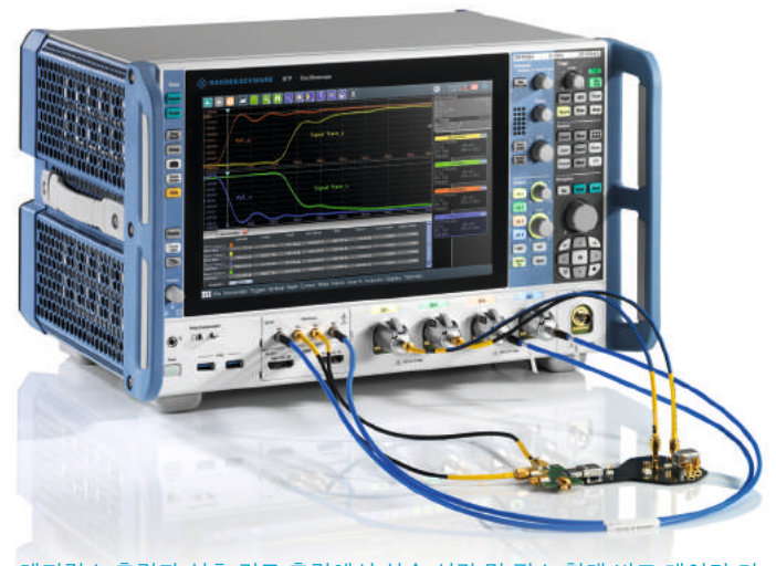
레퍼런스 출력과 신호 경로 출력에서 상승 시간 및 펄스 형태 비교 데이터 기준 디퍼런셜 신호 경로의 시간-도메인-전송 특성 분석.
